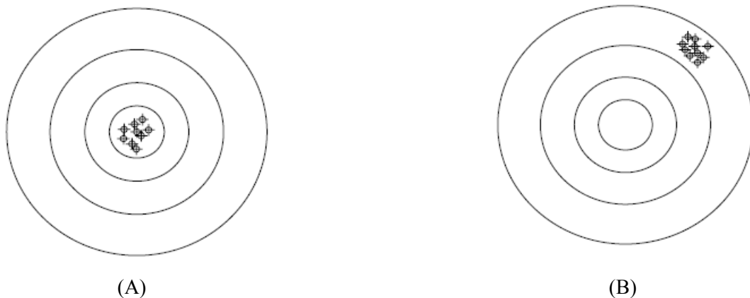
Figura 1: (A) representação de uma condição de alta acurácia e alta precisão, (B) representação de uma condição de baixa acurácia e alta precisão.
